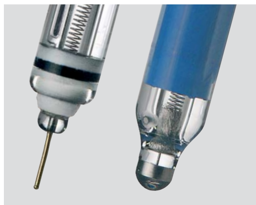
Anillo de platino o pin de oro como electrodo de medida
